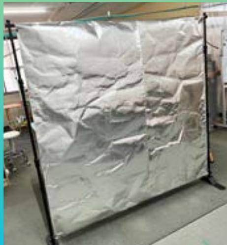
高反射光沢アルミ箔（反射率97%UP） 野外向け＝アルシールL（耐候）もあり
