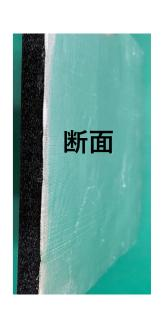
特殊エラストマーは、独立気泡の為、高耐湿性、高耐水性を有し、結露の可能性がある低温保温(冷蔵・冷凍)や野外での保温・凍結防止等にも使用可能です。
