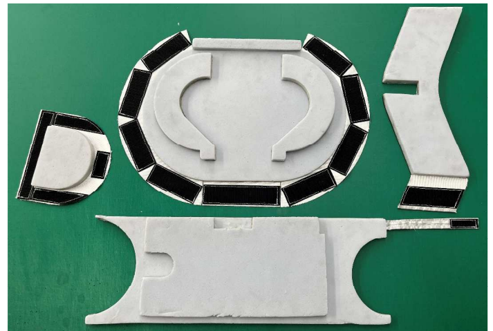
メカニカル真空ポンプ 断熱カバー
